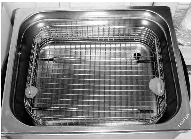
Εικ. 1: Λουτρό υπερήχων καθαρισμού εργαλείων.
