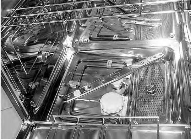
Εικ. 2: Εσωτερικό πλυντηρίου καθαρισμού εργαλείων.
